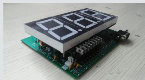
Thiết bị thu thập dữ liệu, điều khiển máy xử lý rác
